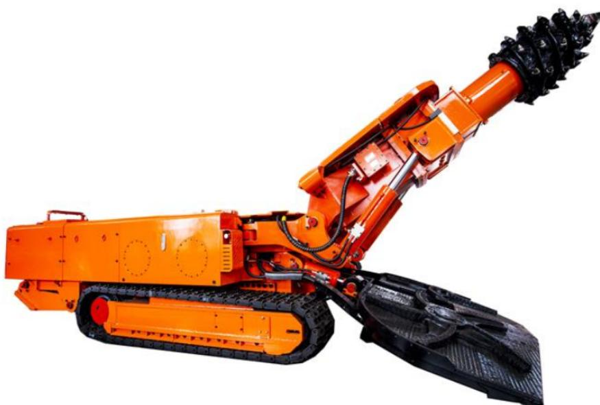
悬臂式掘进机是江苏佳煤公司根据国内小型煤矿巷道的具体开采条件研制的小型多功能掘进机。该产品获国家实用新型五项、外观一项、发明一项。性能特征：1. 是小型多功能掘进机，采用模块化设计，体积小，重量轻，拆装方便，井下运输安装方便。适用于不同断面的掘进；2. 采用德国进口横向切割头，布置合理，受力均匀，切割时振动小，运行稳定，使用寿命长；3. 液压系统采用进口负载敏感和先导操作与国产定量系统集成，高效节能，操作灵活。采用三级过滤器，保证液压油的清洁度，便于更换过滤器，增强液压系统的工作可靠性。双护盾掘进机厂家供应掘进机在正常工作中出现炮头不转一般是电控出现故障。
